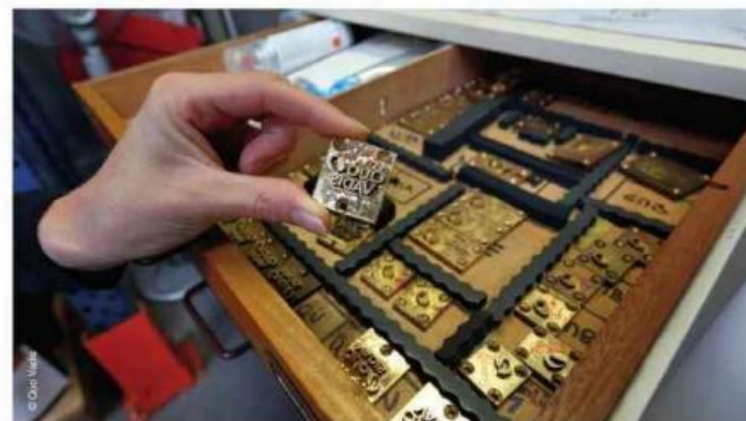
Les « clichés » permettent de personnaliser les agendas en imprimant les logos des entreprises sur les couvertures.
