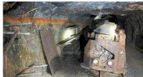
Ce chargeur à moteur thermique a été abandonné au fond dans les années 90. À gauche, on distingue la ligne rouille qui marque le niveau d'eau qui inondait la galerie.
