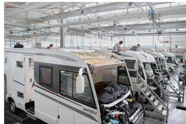
Les camping-cars chez Rapido sont construits en suivant une chaîne en quinze à dix-sept étapes, sur deux jours. Des métiers manuels qui demandent d'abord de l'habileté. | JÉRÉMIAZ GONZALEZ, RAPIDO
