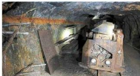
Ce chargeur à moteur thermique a été abandonné au fond dans les années 90. À gauche, on distingue la ligne rouille qui marque le niveau d'eau qui inondait la galerie. Photo: CD - Marie-Hélène MORON
