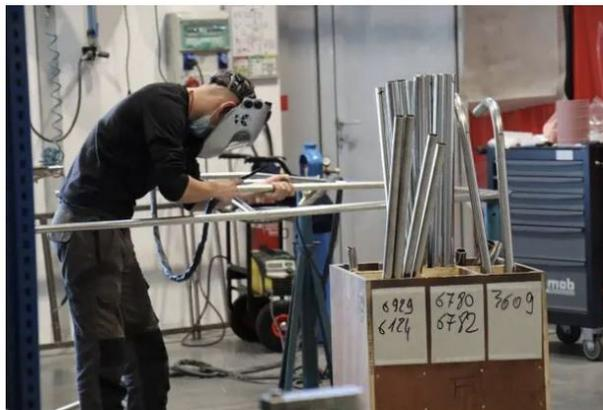
Les armatures en inox des protections de NV Équipement sont soudées sur le site de La Bégaudière. | OUEST FRANCE
