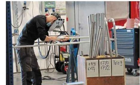
Les armatures en inox des protections de NV Équipement sont soudées sur le site de La Bégaudière.
